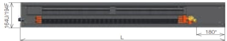
\* Per tutte le lunghezze prodotte del modello PK-OC 8/16 la distanza media delle connessioni è di 180 mm
